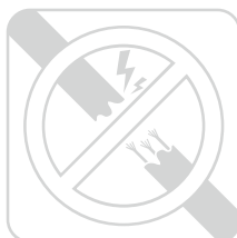
Kontrolloni nëse ka tela të dëmtuar
